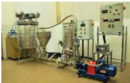
Рис. 3. Многофункциональная промышленно-исследовательская установка УПЭС для приготовления косметической продукции в нетиповом исполнении с дополнительными возможностями по созданию разрежения в рабочей емкости, регулируемой дозируемой дозагрузкой расплава жирового компонента непосредственно в поток циркулирующего продукта, принудительной подачей густого продукта в рабочую зону насоса-гомогенизатора
