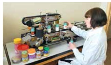
Рис. 6. Малогабаритная этикетировочная машина ЭМ-4П.Мини для нанесения самоклеящихся этикеток на боковую поверхность тары. Модификация машины с цифровой системой управления позволяет за один цикл работы наносить на цилиндрическую тару этикетку и контрэтикетку (при поочередном расположении этикеток и контрэтикеток на ленте)
