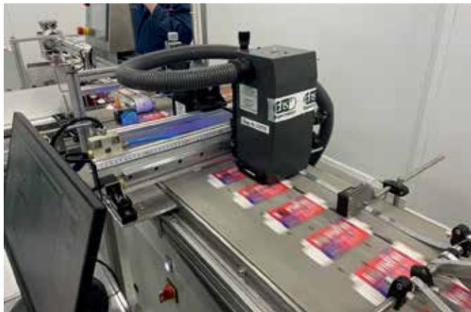
Линия маркировки с высокоскоростным пролистывателем под управлением МТД. Маркировка
