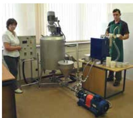
Рис. 1. Пример организации производственного участка по приготовлению на установке приготовления эмульсий и суспензий УПЭС-0,1/3,0 и розливу в потребительскую тару на полуавтомате розлива УД-2 продукции в виде эмульсии, суспензии, геля или раствора
