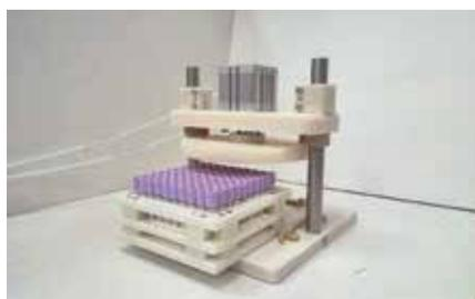
Рис. 5. Устройства укупорки при изготовлении адаптируются к различным видам тары и укупорочных средств. На фото, в качестве примера, специальное нетиповое устройство УУ-4ПН(Н) для одновременной укупорки партии контейнеров для отбора анализов (предназначено для работы совместно с камерой вакуумирования)
