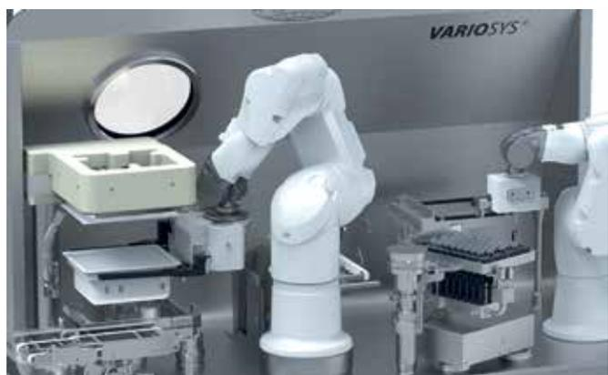
Рис. 2, 3. Роботы для чистых помещений и сменные модульные станции обеспечивают высокую универсальность линии.
