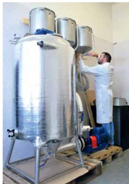
Рис. 2. Наладка установки УПЭС-0,15/3,0В в о взрывозащищенном исполнении с дополнительными мерными емкостями для подачи компонентов в процессе приготовления продукта
