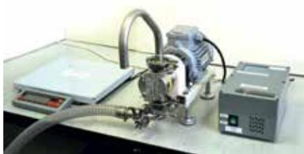
Рис. 4. Новая перспективная разработка специалистов ИТП «ПРОМБИОФИТ» — установка AP-1I розлива жидких и пастообразных продуктов с импеллером и цифровой системой управления
