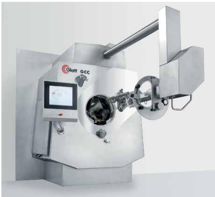
Барабанная установка для нанесения покрытий типа GCC
