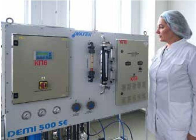
Установка для подготовки воды очищенной DEMI 500 SE, WATEK
